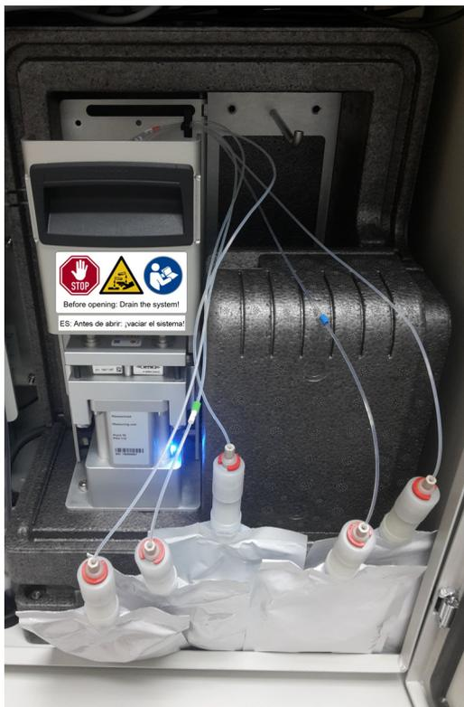
figura 5-7 ChemBag rimossa per la sostituzione
